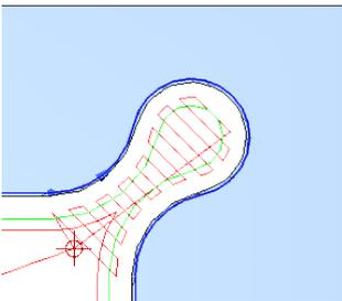
Figura 6. Modificando l'ordine delle operazioni in modo da eseguire la realizzazione di tasche tra la sgrossatura e i ripassi consente di avere un percorso filo più efficiente.
